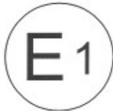
für einen Typ eines Fahrtrichtungsanzeigers nach der Regelung Nr. 6
